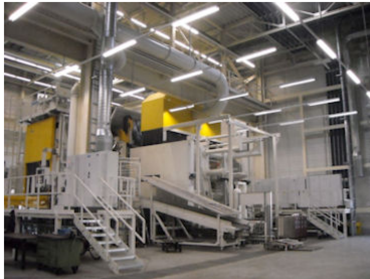
埃斯林根-梅廷根意特 TF 机型镁合金压铸单元
