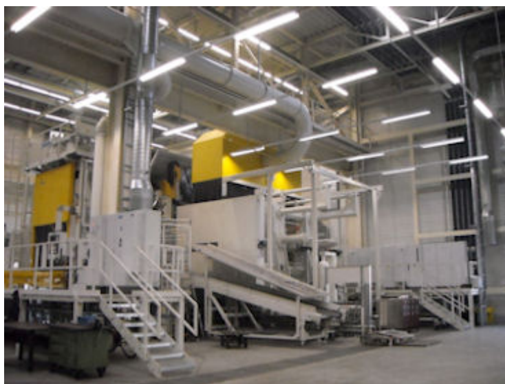
埃斯林根-梅廷根意特 TF 机型镁合金压铸单元
